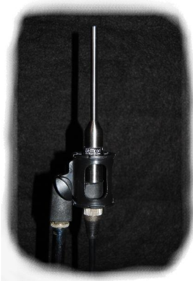
Das Bild links zeigt das iSEMcon EMX-7150 mit Mikrofonspinne (Shockmount) und Mikrofonständer in Diffusfeld-Ausrichtung.
